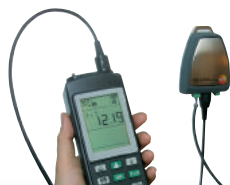
Inspección de transmisores con interface de 4 a 20 mA
